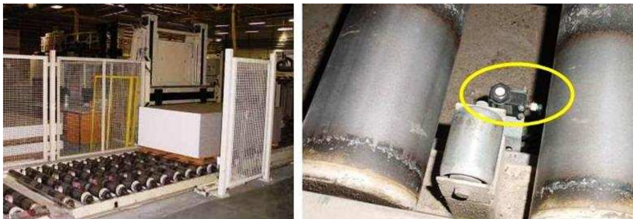
UPX Ultraschallsensor zwischen den Transportrollen
